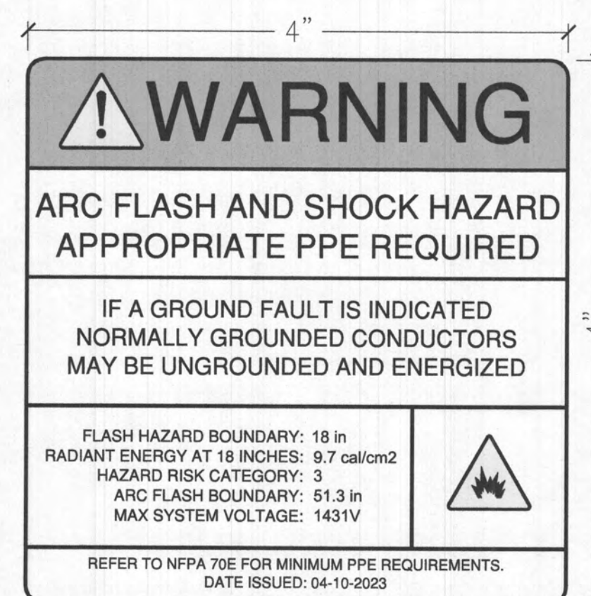
N LABEL 16 REQUIRED SCALE: 1" = 1" ONE PER INVERTER
